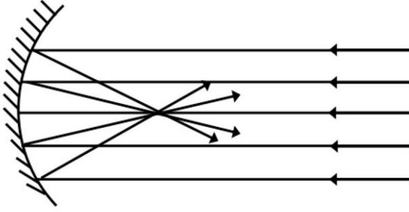
(3) 凹面镜的聚光原理：近光灯射出，扩大光照面积。做一示意图，分别从 b 点（即原图中 C 点）和 a 点（即原图中 D 点）向镜面作两条入射光线，按照光的反射定律，画出两点入射光线的反射光线，如下图所示：
