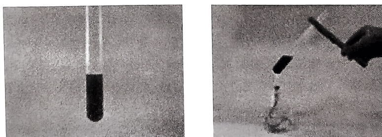
图 8-24 用新制氢氧化铜检验葡萄糖
