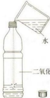
图6-15 二氧化碳的溶解性实验
