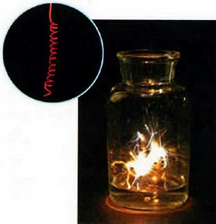
图2-13 铁丝在空气中红热，在氧气中剧烈燃烧
