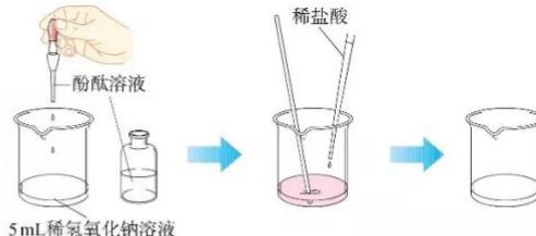
图 10-14 在氢氧化钠溶液中滴加稀盐酸
