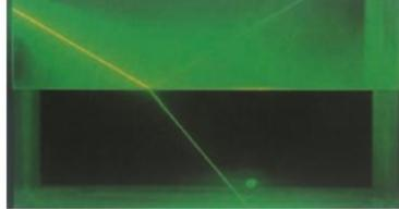
图4.4-1 光射入水中时的折射现象
